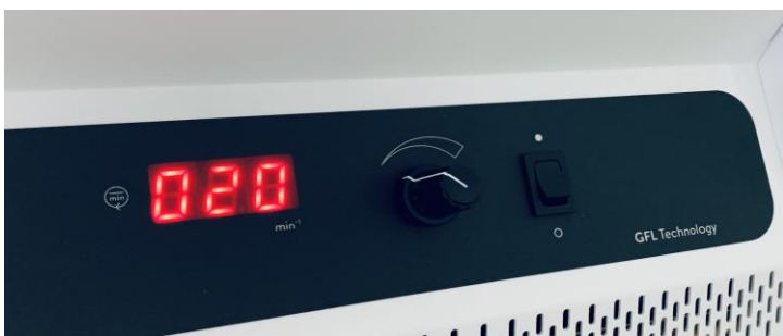
Pupitre de conduite pour le réglage et l'affichage de la vitesse
